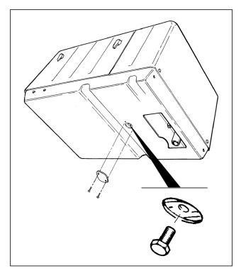
FIGURE 7. OIL DRAIN PLUG
